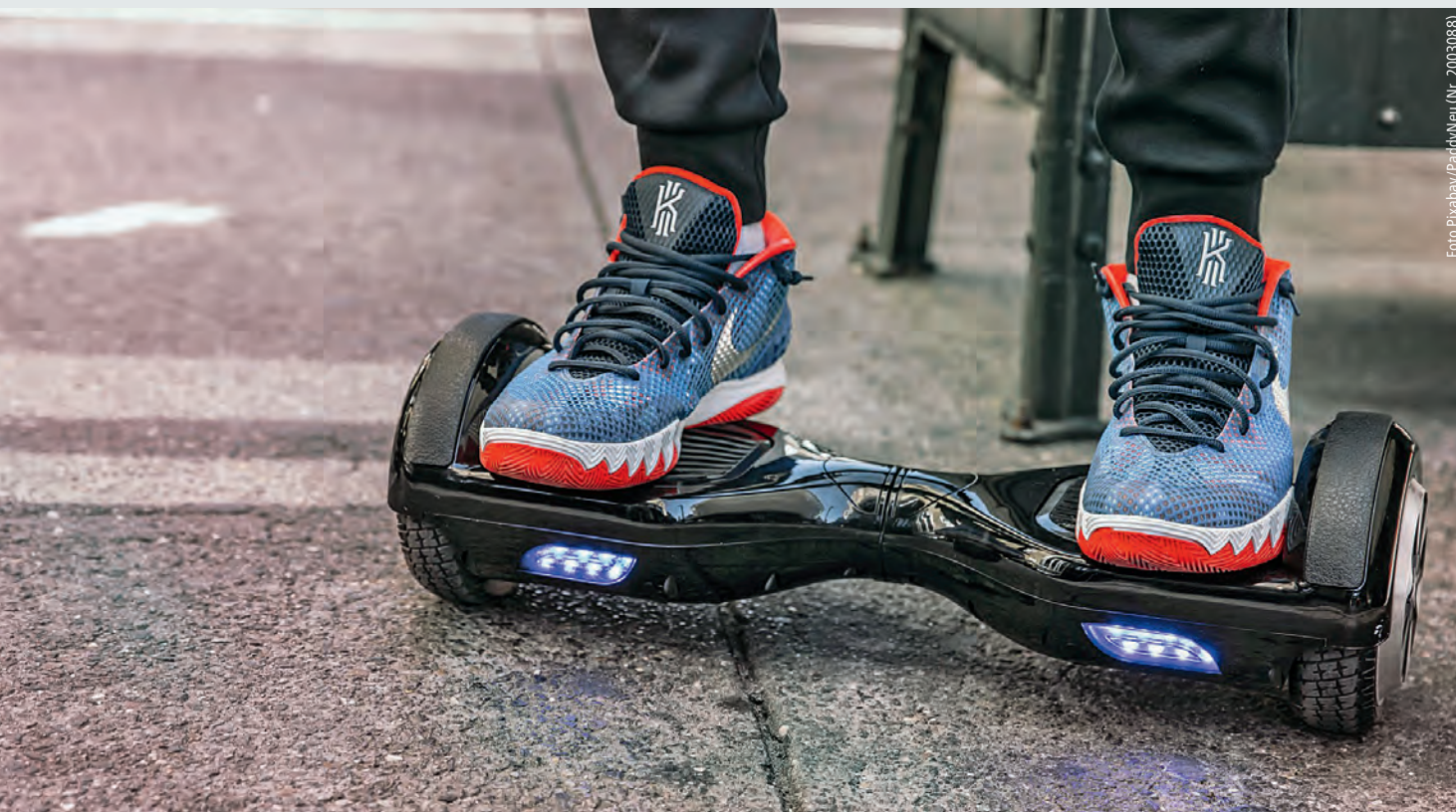
Abb. 1: Hoverboards mussten schon mehrfach zurückgerufen werden, weil der Akku beim Ladevorgang in Brand geriet.
