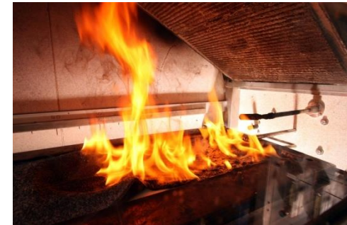
Brandschutzprüfung an Bodenbelägen
