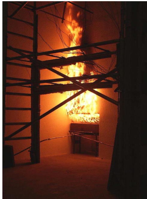
Brandschutzprüfung an einem Wärmedämmverbundsystem (WDV-System) (c) Feuerfritz Network GmbH, 2018
