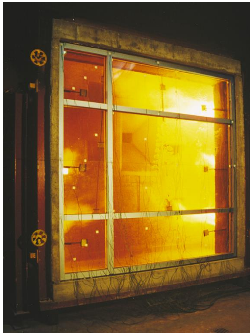
Brandschutzprüfung an einer Glaskonstruktion
