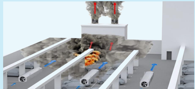
Rauchabschnittsbildung durch lufttechnische Maßnahmen
