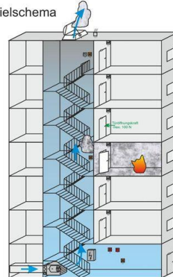
Spüllüftung ohne Druckaufbau
