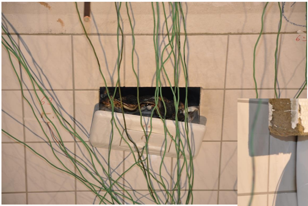
Drückerplatte schmilzt nach 3 Minuten ab
