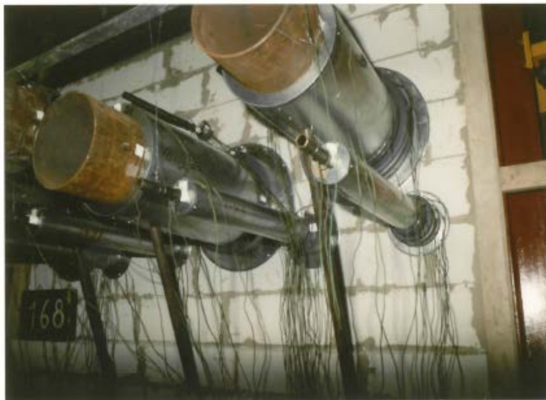
Abb. 5: Die vom Feuer abgekehrte Seite mit Lage der Meßstellen (c) FeuerTRUTZ network GmbH
