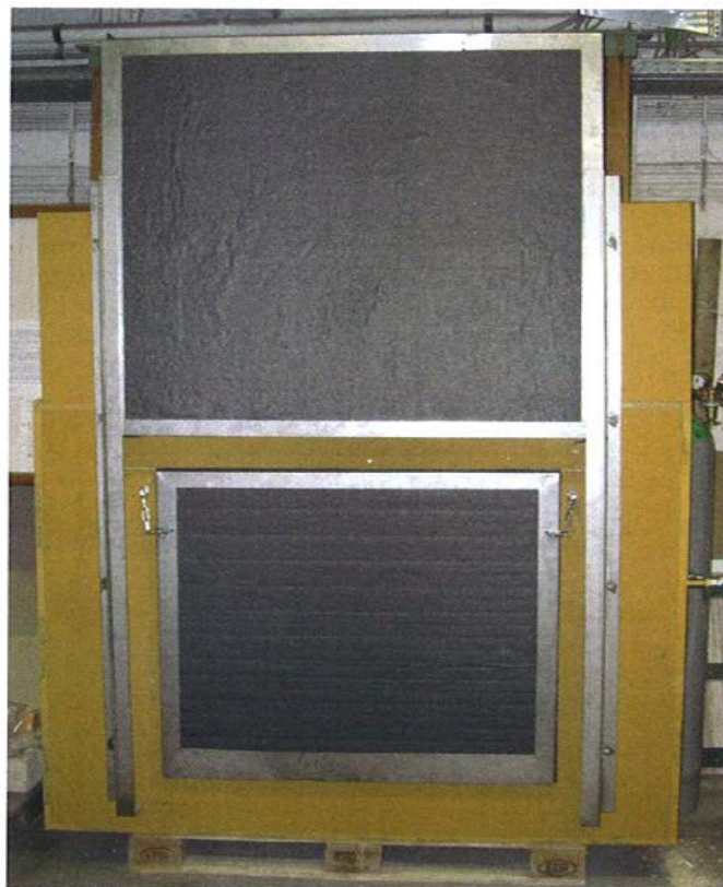
Bild 1: Versuchsaufbau der Version 1 (Berstelement und Nachführeinheit gesichert) (c) FeuerTRUTZ Network GmbH
