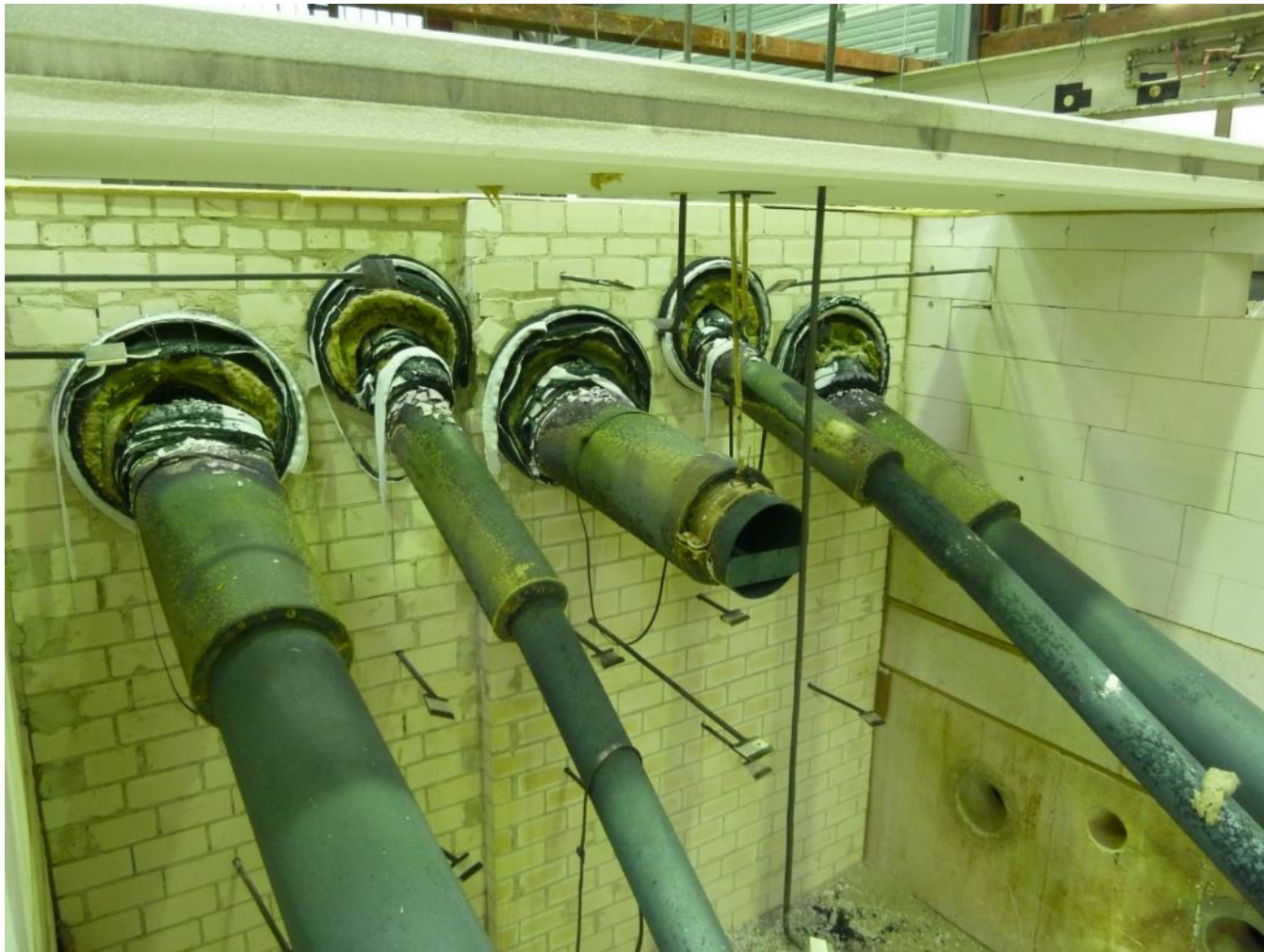
Schlachtfeld Feuerseite nach dem Brandversuch
