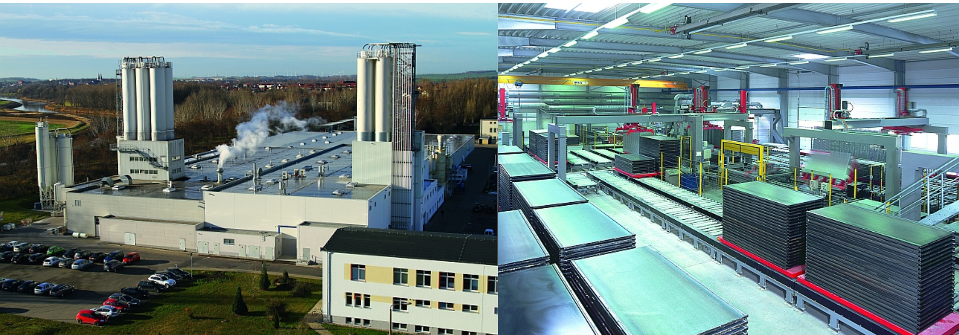
Aestuver Werk Calbe an der Saale – automatisiert Produktion von Brandschutzplatten (2,4 Mio. m 2 /a)
