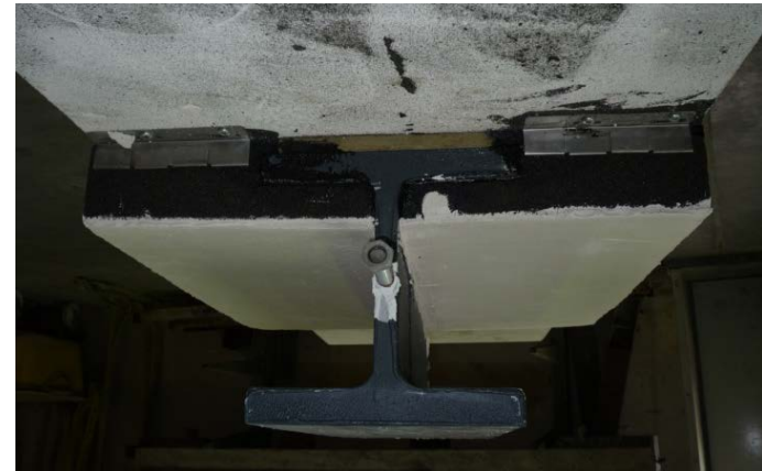
Stahlträger vor dem Brandversuch
