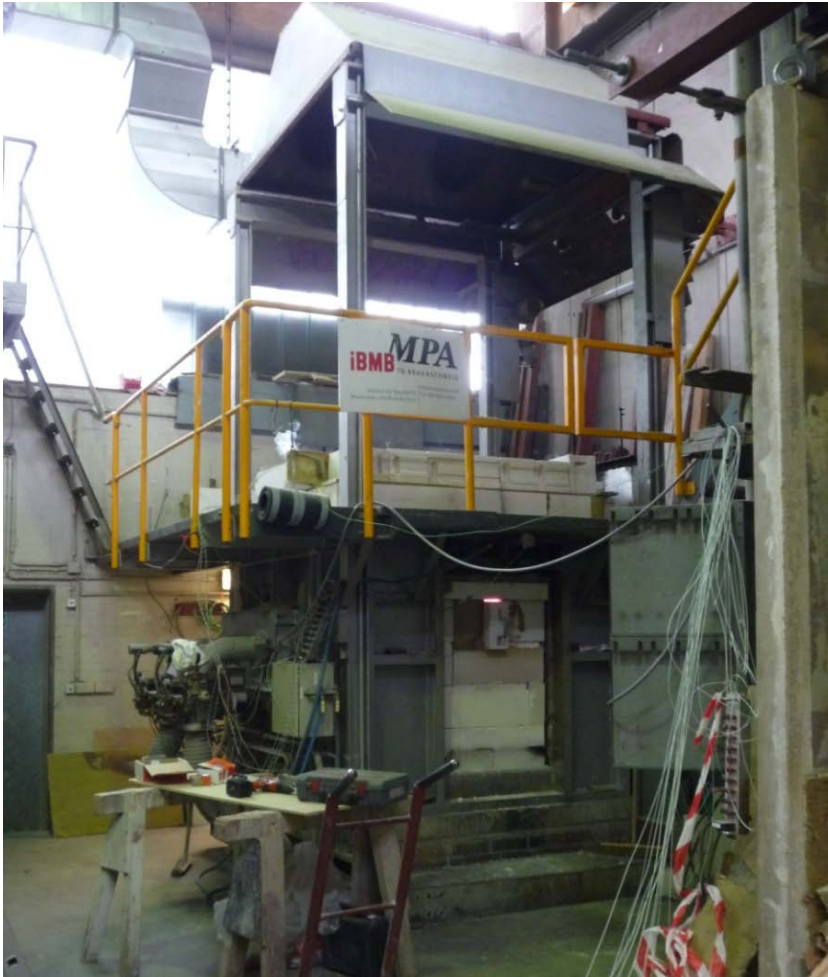
Brandversuch nach DIN 4102-2
