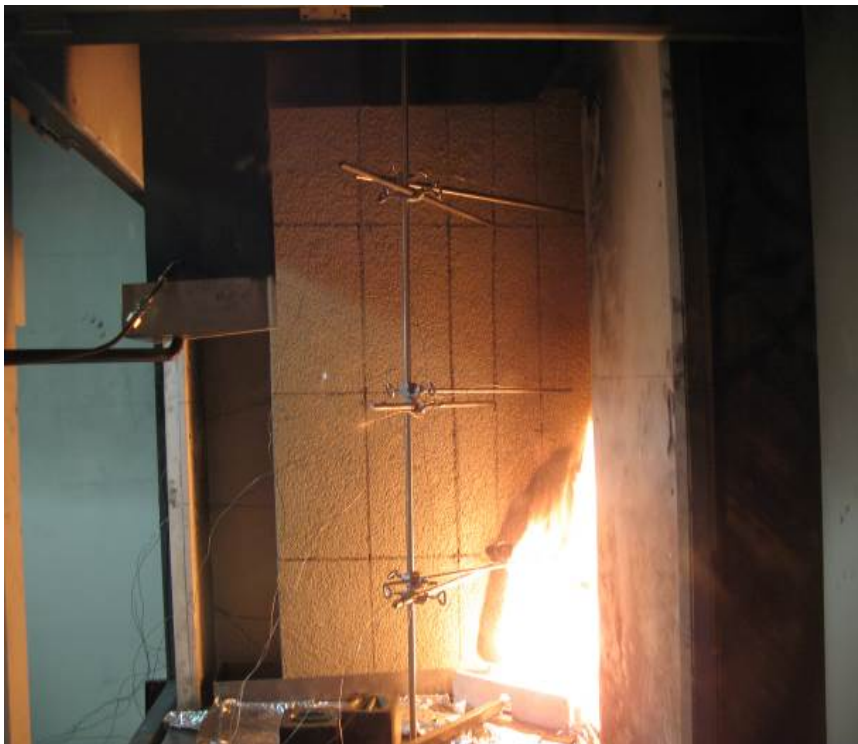
Vorversuch01: kleine Beschädigung, Leistung des Brenners: 30 kW
