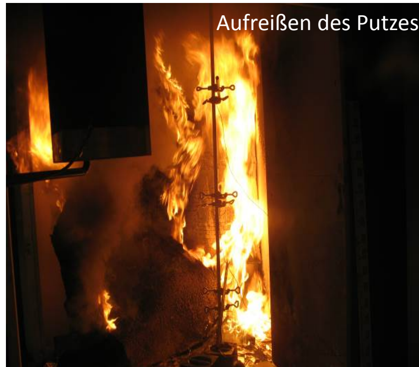
Vorversuch02, größere Beschädigung Leistung des Brenners: 123 kW
