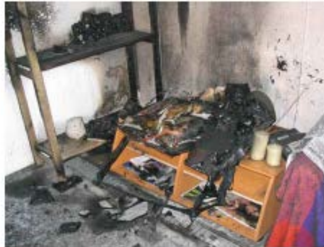
TV Brand, Tür offen, ohne Sprinkler
