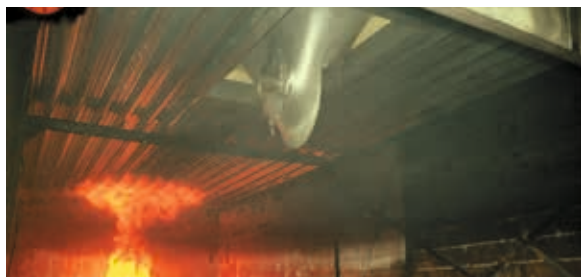
Lichtkuppel aus Acrylglas als Wärmeabzug.
