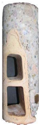
Bild 4.2-2: Querschnitt der tragenden Decke
