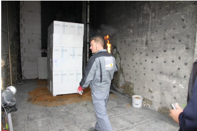
„Molotow-Cocktail“ auf Boden direkt vor EPS- Stapel geworfen
