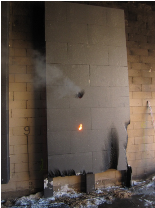
„Bengalo“ in die EPS- Dämmung gesteckt
