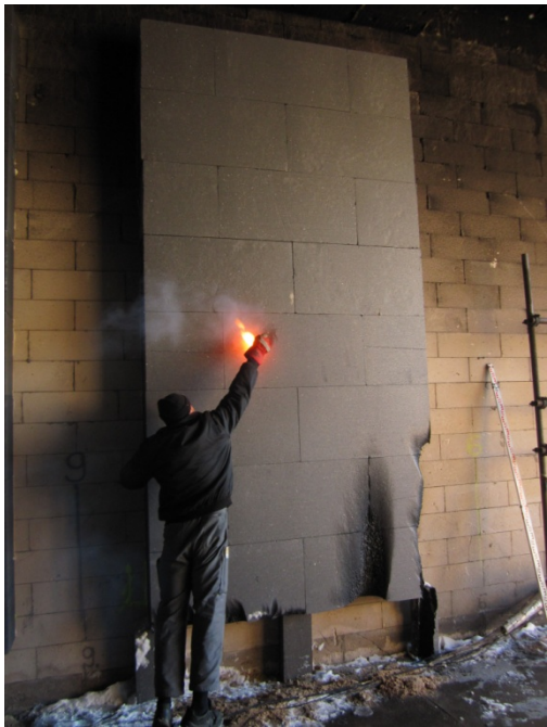
„Bengalo“ in die EPS- Dämmung gesteckt
