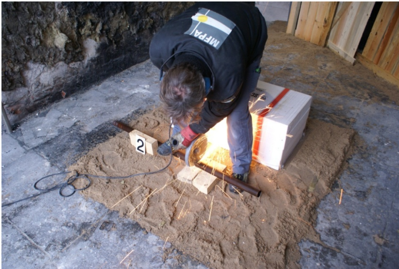
Stahlrohr durchtrennen mit der Flex
