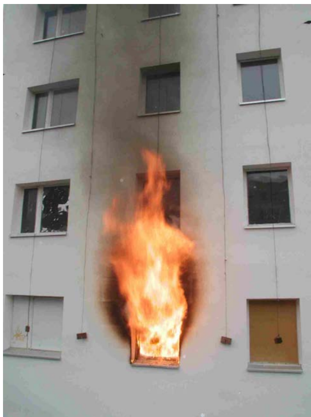
Vollbrand, Primärflamme bis zum Fenstersturz der nächsten Etage
