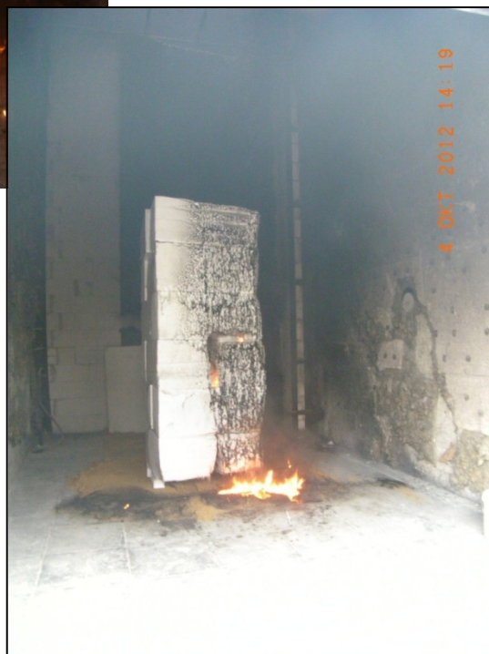
1 l Benzin flächig verschüttet
