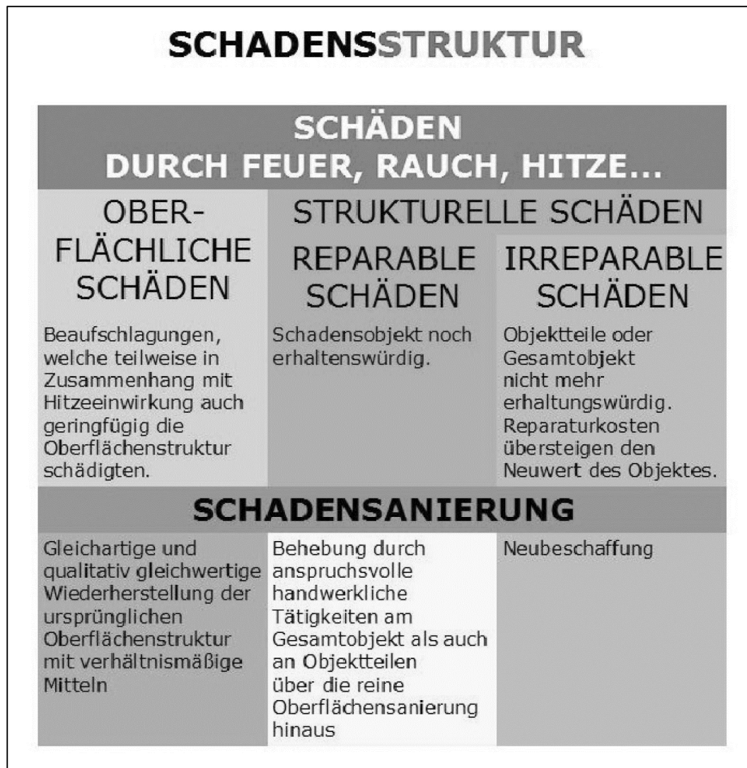
Abb. 5: Schadenstruktur: Schadensanierung zur Wiederherstellung der Produktionsfähigkeit in Anhängigkeit der Schadenstruktur.
