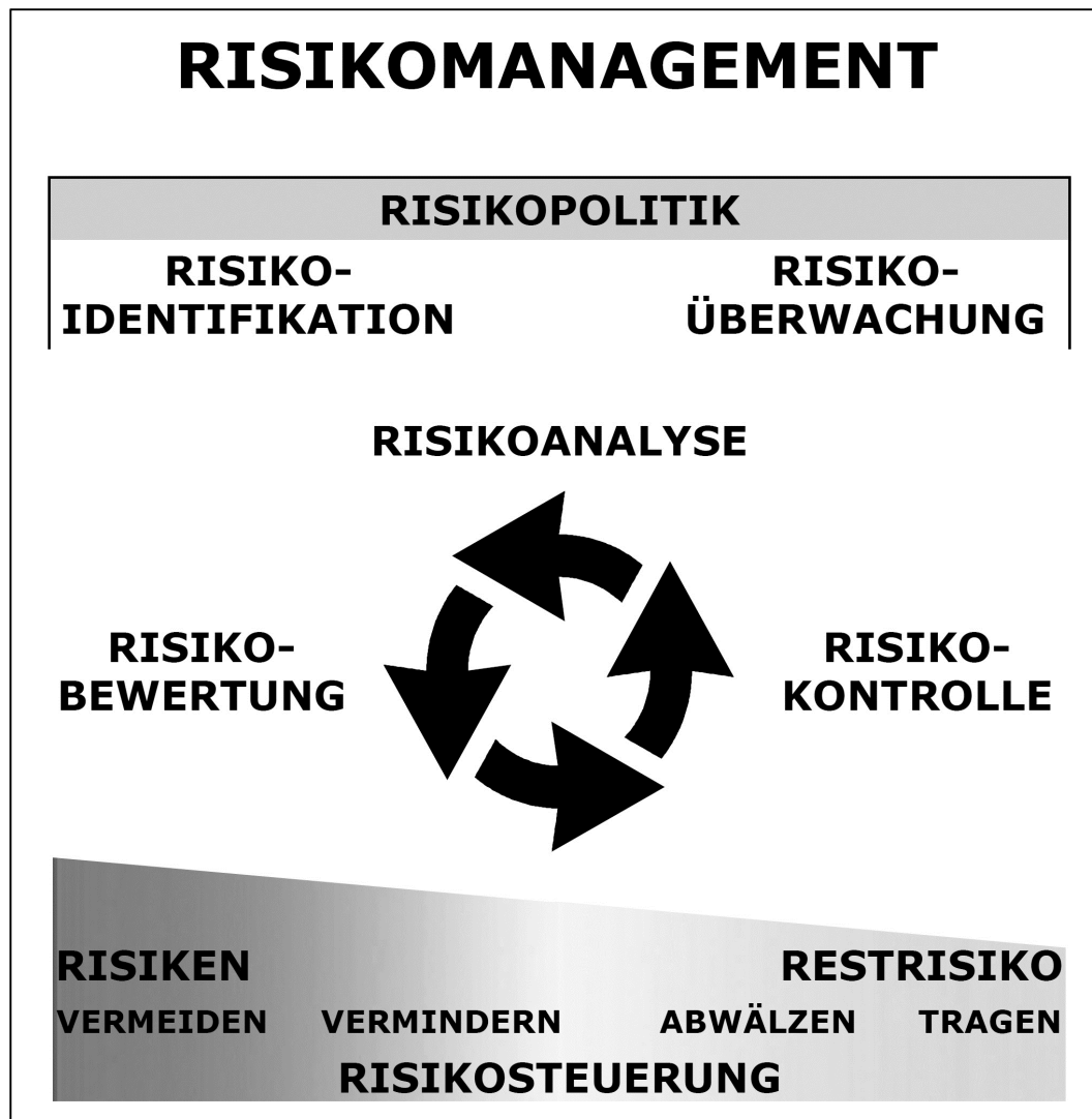
Abb. 2: Risikomanagement: Fortlaufender Prozess eines Regelkreises zur systematischen Erkennung, Analyse, Bewertung, Überwachung und Kontrolle von Risiken.
