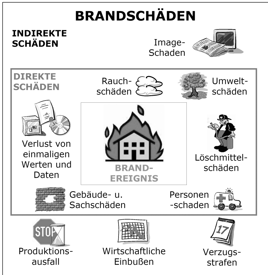
Abb. 4: Brandschäden: Direkte und indirekte Brandschäden
